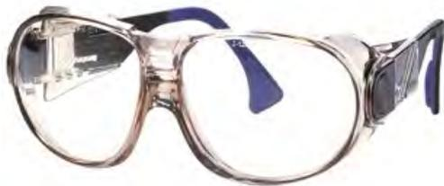
Lenti chiare in policarbonato con trattamento UVEX Supravision Plus (antiappannante, antigraffio, anti-UV 400, antistatico), adattamento perfetto al viso grazie al sistema di inclinazione micrometrico integrato, regolazione della lunghezza, delle stanghette in 4 posizioni con fermo automatico, super leggero con ampio campo visivo, stanghetta Duo-Flex.
