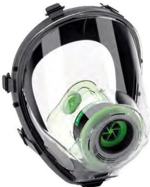
Taglia universale, bardatura regolabile a sgancio rapido a sei punti di attacco e guarnizione esterna in gomma sintetica. Schermo panoramico, oronasale dotato di due valvole di inspirazione per evitare appannamenti. Attacco per il filtro filettato secondo la norma EN148-1 per essere utilizzato con tutti i dispositivi dotati di raccordo maschio.
