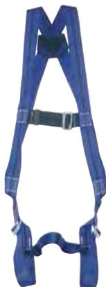
Imbracatura a 1 punto di ancoraggio dorsale, in tessuto poliestere di lunga durata, anello a D dorsale in acciaio galvanizzato completamente scorrevole per un maggior confort, nastro sub-pelvico per ulteriore confort e sicurezza, fibbie accoppiate su petto e gambe, nastro pettorale da 45 mm in poliammide con fibbia metallica ad apertura rapida. Peso 500 g.
