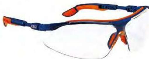
Monolente chiara con trattamento Supravision Excellence in policarbonato antigraffio all'esterno e antiappannante all'interno, eccellente protezione laterale e protezione sopraccigliare assorbi-urti, protezione dai raggi UV 400, stanghette Quattroflex in policarbonato e gomma, morbide, flessibili e regolabili in inclinazione e lunghezza, ventilazione indiretta, ampio campo visivo.
