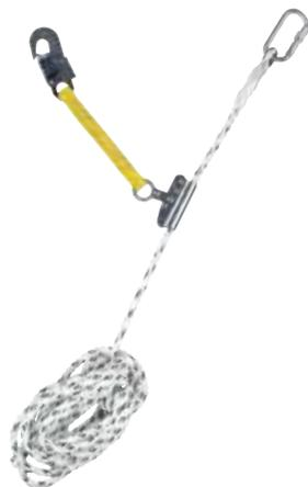
Realizzato in acciaio inox leggero, duraturo e resistente alla corrosione, comprensivo di linea di ancoraggio a fune, diametro 12 mm, lunghezza 15 m, si blocca automaticamente lungo la fune in caso di caduta, si sposta sulla fune senza interventi manuali, il cordino da 30 cm ed il connettore facilitano il collegamento all'imbracatura.
