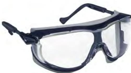
Protezione completa degli occhi grazie al telaio con appositi agganci posto nella parte interna della lente, profilato in morbido elastomero per una migliore aderenza al viso senza pressione, stanghette regolabili in inclinazione ed estensione, monolente incolore filtro UV 2-1.2, con trattamento Uvex Supravision Excellence, protezione dai raggi UV 400.
