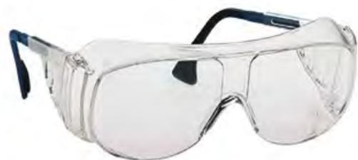
Ampio campo visivo grazie alla lente panoramica chiara estremamente resistente ai graffi e agli agenti chimici, parte superiore della montatura opacizzata per evitare infiltrazioni di luce diretta, stanghette Duo-Flex e relativa regolazione della lunghezza in 3 posizioni con fermo automatico, sistema di ventilazione laterale integrato, adatto per essere indossato sopra qualsiasi occhiale correttivo.
