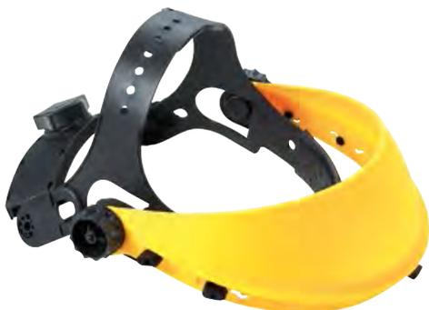
Semicalotta ergonomica in materiale anallergico, fascia frontale antisudore in spugna intercambiabile, banda superiore per la regolazione dell'altezza della calotta, regolazione circonferenza cranica tramite cremagliera (da 53 a 61 cm), ribaltabile di 90° tramite frizioni, 5 punti di aggancio per lo schermo, certificato con i simboli per il campo di utilizzo 3 della EN166 per protezione da schizzi liquidi, resistente ad impatti e a temperature estreme.
