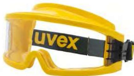
Lente chiara in policarbonato ad alta resistenza meccanica, antiappannante all'interno con trattamento Supravision Excellence e antigraffio all'esterno, a tenuta di gas, protezione dai raggi UV 400, bardatura elastica regolabile, priva di ventilazione per essere utilizzata anche in presenza di gas, vapori e fumi.
