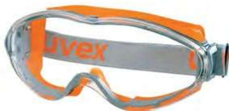
Lente chiara in policarbonato con trattamento Supravision Excellence antiappannante all'interno e antigraffio all'esterno, bardatura elastica regolabile, facilità di sostituzione della lente grazie al sistema click-in e ampio campo visivo e possibilità di utilizzo con occhiali da vista, nasello anatomico e profilo facciale in morbida gomma.
