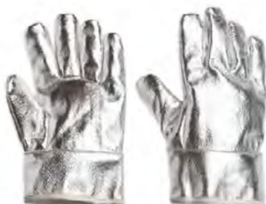
Palmo e dorso in fibra aramidica alluminizzata spessore 1,1 mm, foderati in TNT ignifugo 0,7 mm, manichetta in tessuto aramidico alluminizzato foderato in TNT ignifugo, cuciture con filo di Kevlar.
