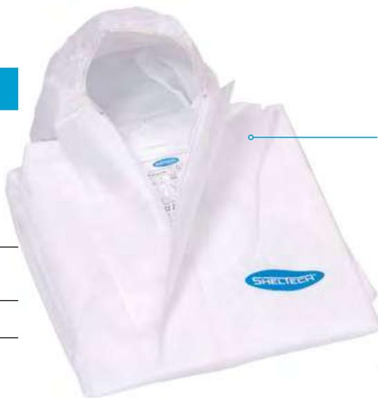
Indumento protettivo in speciale materiale in tessuto SMS, a rilascio particellare nullo, con trattamento antistatico, completo di cappuccio con elastico, cerniera lampo nella parte anteriore con patta copri-cerniera e striscia adesiva per garantire ermeticità contro i liquidi, polsi e caviglie elasticizzati, elastico posteriore in vita per una elevata aderenza al corpo.
