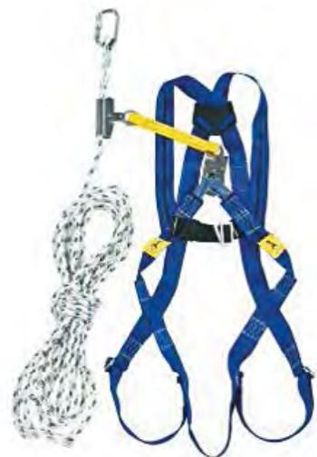
Kit compreso di imbracatura a 2 punti di ancoraggio con attacco dorsale e sternale (tramite asole) e dispositivo anticaduta di tipo guidato con 10 m di fune (diametro 12 mm) e collegamento di 30 cm.
