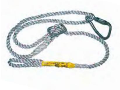
Cordino di posizionamento sul lavoro, fune in 100% poliammide diametro 12 mm, lunghezza 2 m regolabile, dotata di un moschettone Twist-lock in lega leggera CML 120S, è importante utilizzare esclusivamente moschettoni con bloccaggio automatico e non a ghiera.
